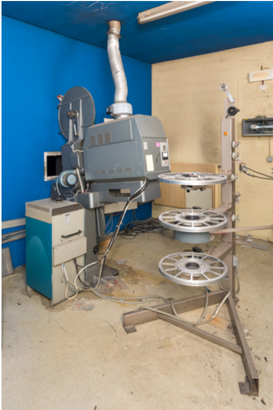
Redresseur Irem N3-X75/95DM, projecteur Cinemeccanica Victoria 8 r et enrouleur-dérouleur de film ST200. 71, Montceau-les-Mines, 13 rue Ferrer
