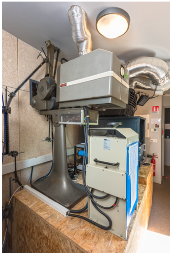
Projecteur Fedi XV T et son redresseur Irem N3-X75DM, depuis le fond de la cabine. 71, Anost, 4 place de la Bascule
