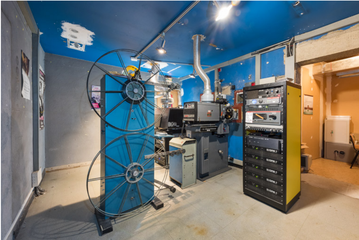
Vue d'ensemble de la cabine depuis l'entrée. Au centre l'enrouleur-dérouleur vertical Idef, le redresseur Prevost et le projecteur Simplex.
