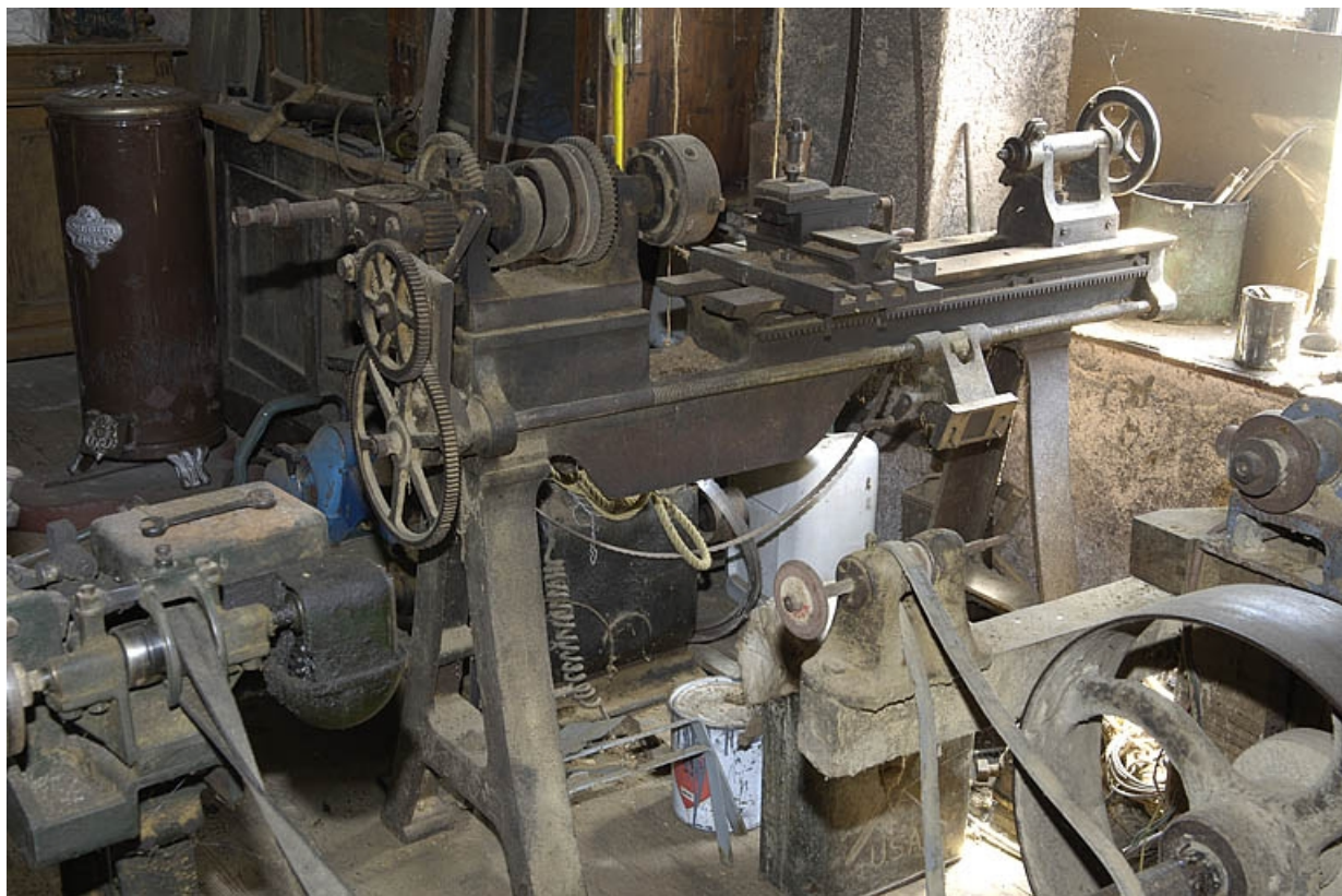
Premier étage. Tour à bois horizontal.
