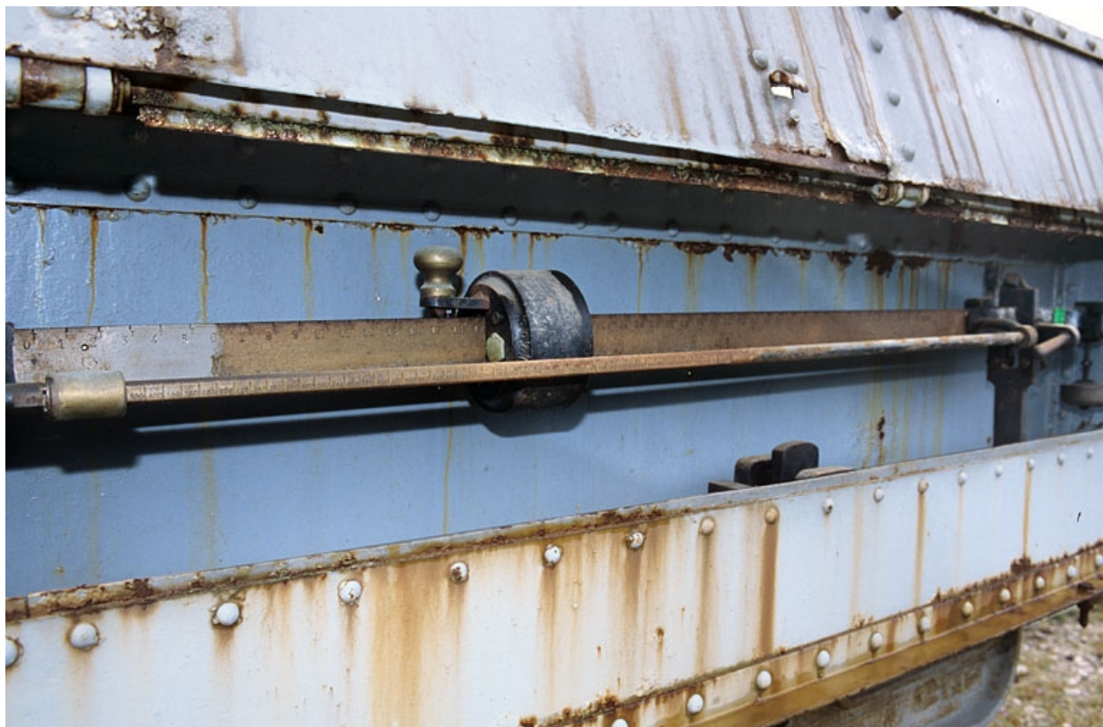
Appareil indicateur : le fléau à la romaine.
