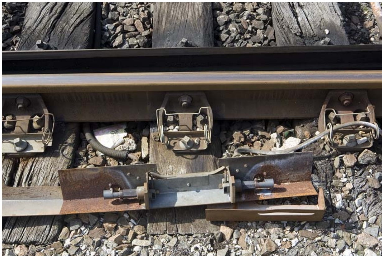
Exemple de rampe de réchauffage au gaz, sur un autre appareil : la rampe démontée.
