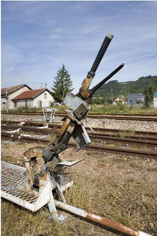
Levier de manoeuvre enclenché. Levier de taquets d'arrêt, pour certaines voies à l'ouest, à l'extrémité de la gare côté La Cluse. 39, Champagnole, 13 avenue de la Gare
