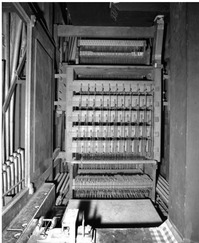
Mécanique de la machine pneumatique Barker.
