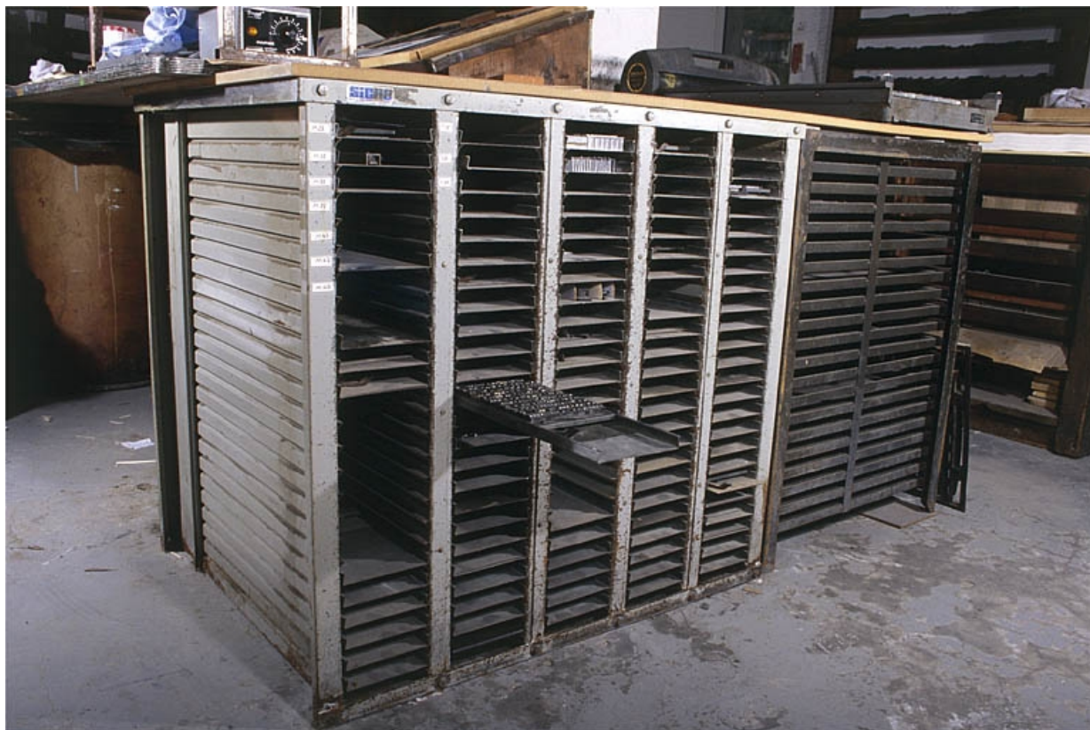
Deuxième meuble à galées, de trois quarts gauche. Une composition est placée sur la galée à demi tirée.
