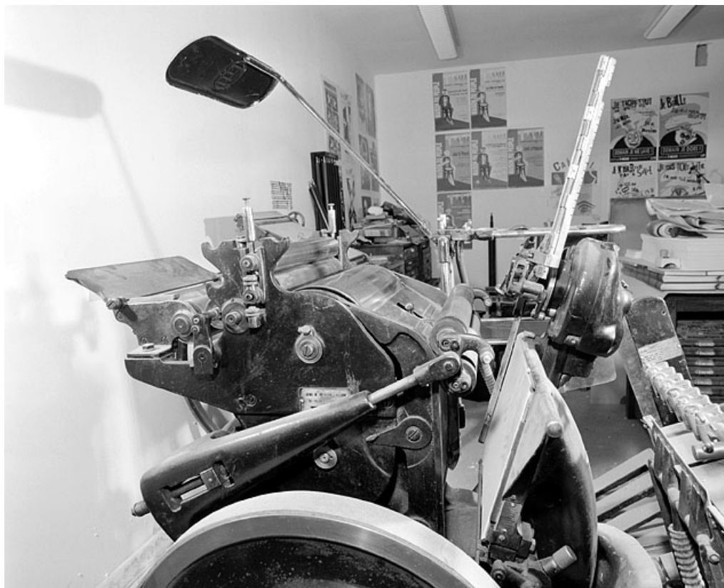
Détail de la machine, depuis la gauche. Encrier et système encreur à gauche, platine à droite, surmontée par l'un des bras du margeur automatique.
