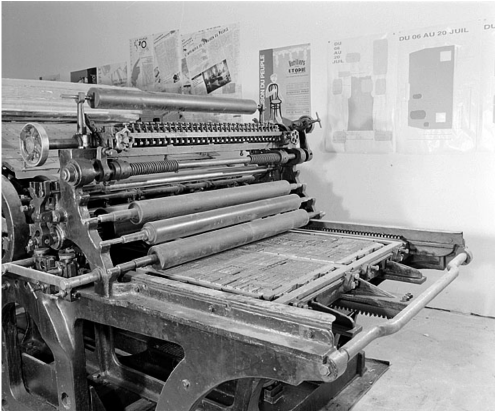
Partie avant de la machine. Système d'encrage vertical (encrier et rouleaux encres) à gauche, marbre portant une forme et sa composition à droite.
