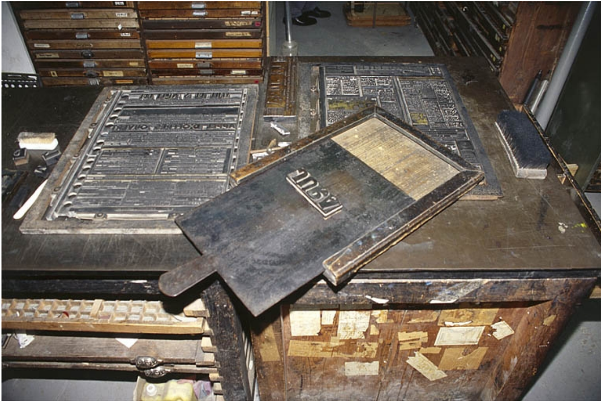
Galée en acier, posée sur un marbre.
