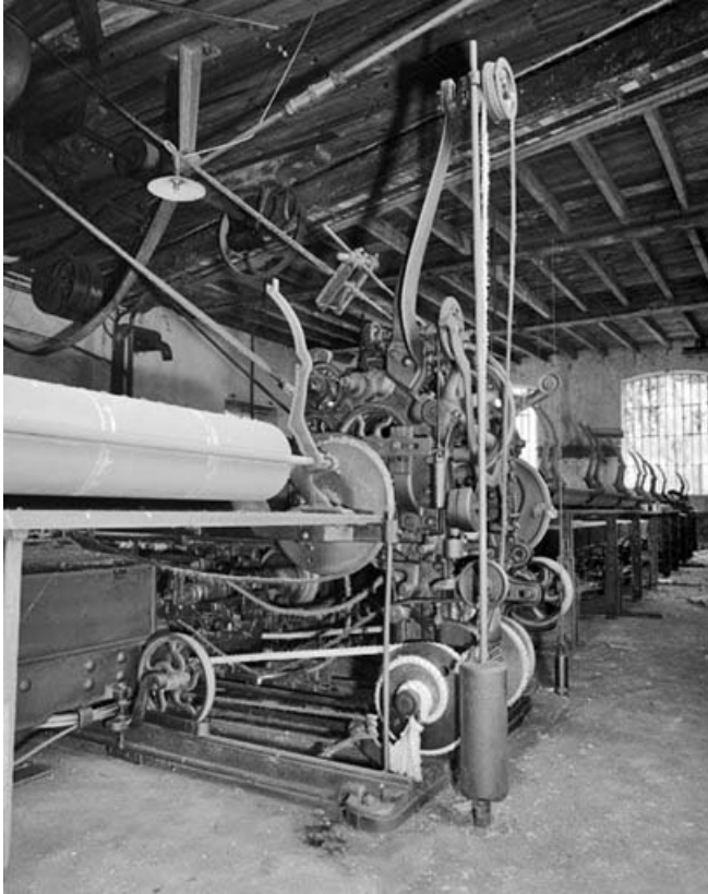
Système moteur : partie arrière vue de la gauche. Les mouvements du chariot sont commandés par la poulie à gorge de forme spéciale (dite scroll) sur laquelle s'enroule la corde.
