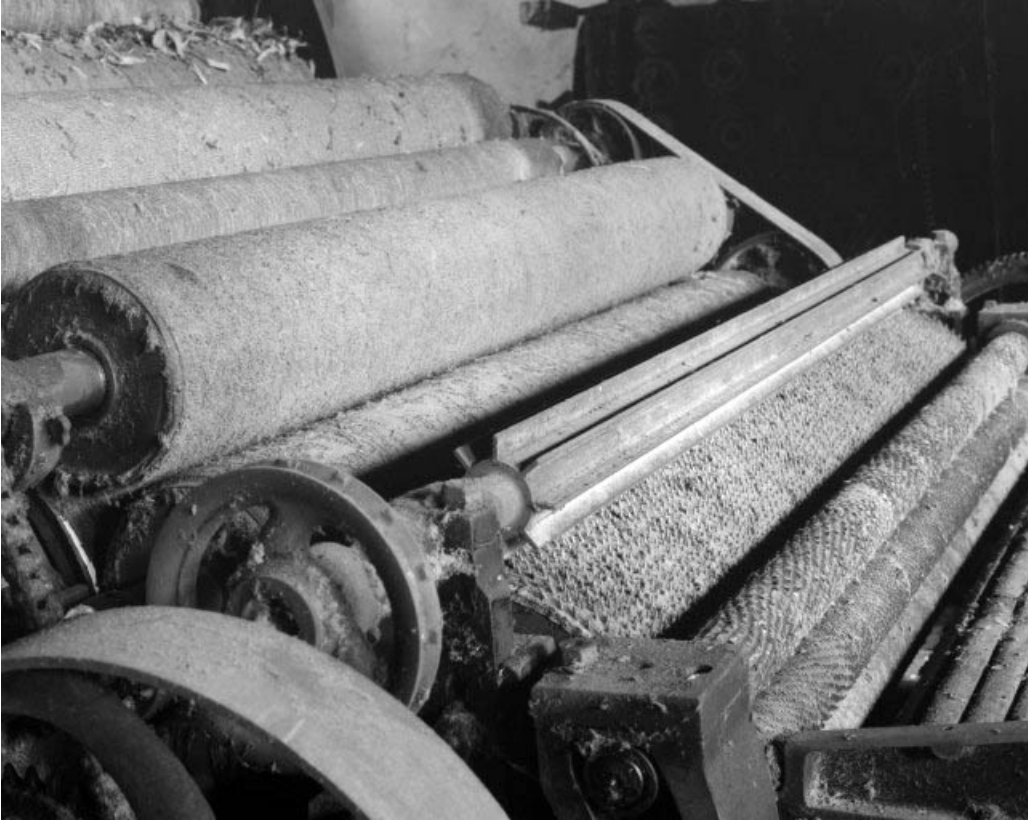
Détail du cylindre briseur. De droite à gauche, rouleaux alimentaires, cylindre briseur puis cylindres cardes de l'avant-train. 39, Balanod, lieudit : sous Roches
