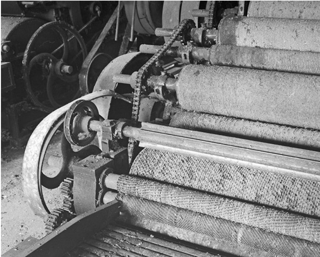
Détail du cylindre briseur. De gauche à droite, rouleaux alimentaires, cylindre briseur puis cylindres cardes de l'avant-train. 39, Balanod, lieudit : sous Roches
