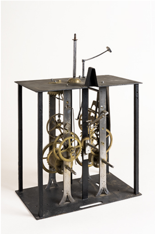
Mouvement d'horloge comtoise (mouvement "cage fer"), 19e siècle.
