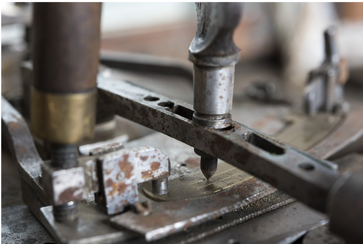
Module de gravage : la pointe à graver.
