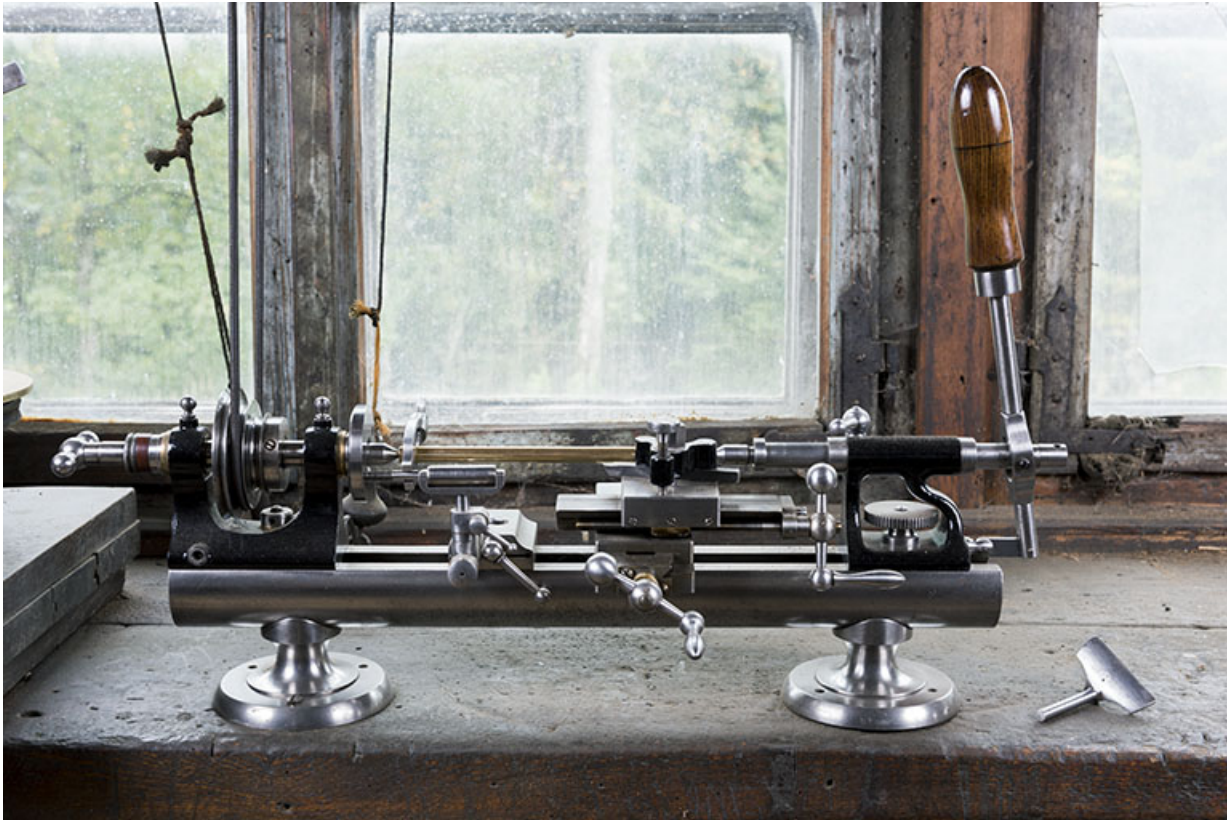
Grand tour, vu de face. A droite, un support d'outil à main. 25, Les Gras
