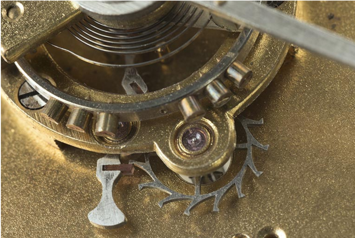
2e porte-échappement : ancre de côté et roue d'ancre.
