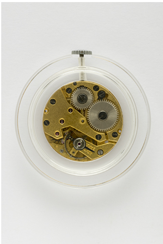
Mouvement Parrenin HP 87 : face côté ponts.
