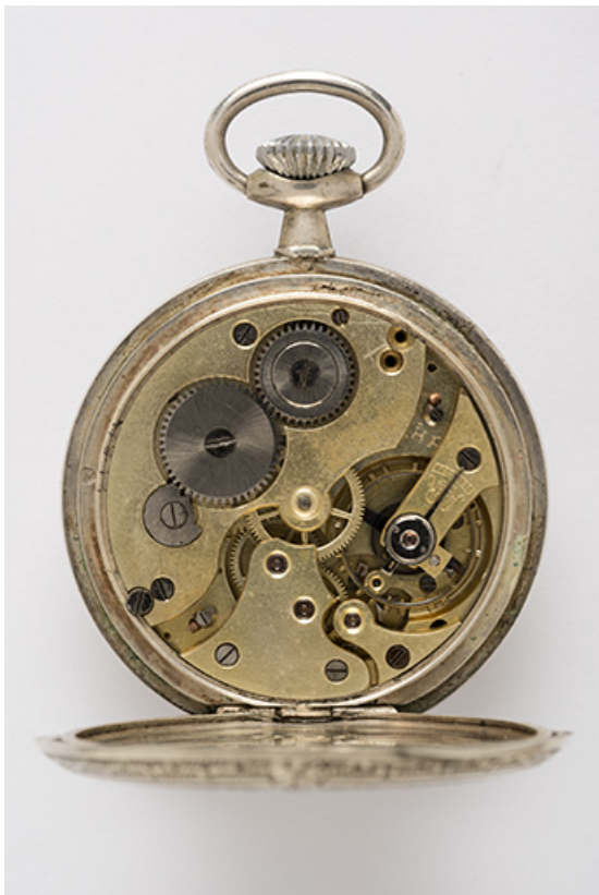
Montre de gousset mécanique des Ets Victor Mougin : mouvement Parrenin HP modèle T. (Collection particulière : Jean-Claude Vuez, Villers-le-Lac).
