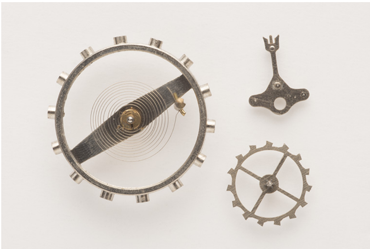
Vue d'ensemble de l'assortiment : balancier-spiral à gauche, ancre à chevilles en haut, roue d'ancre en bas. 25, Charquemont, 12 Rue Neuve
