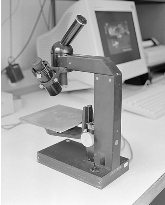
Microscope utilisé pour le contrôle des montres. La cellule photoélectrique fixée sur le côté permet de vérifier l'affichage des secondes.
