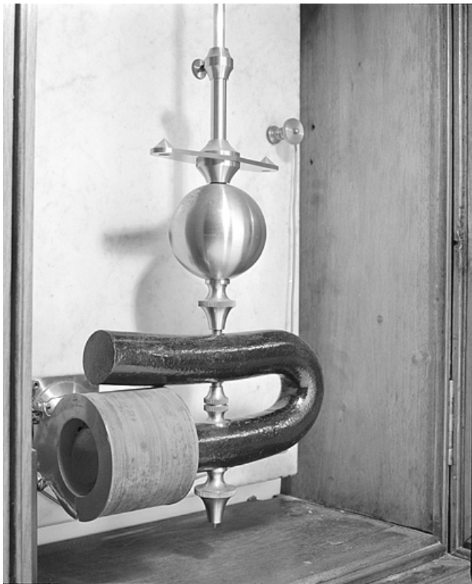
Le balancier (avec masse circulaire et aimant).
