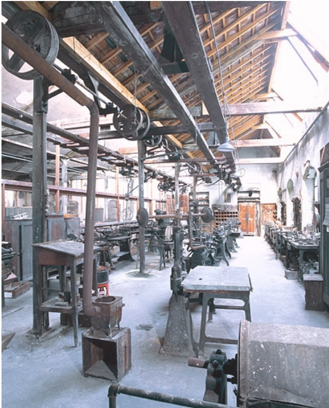
Atelier de mécanique. Vue de l'arbre de transmission distribuant l'énergie aux machines.
