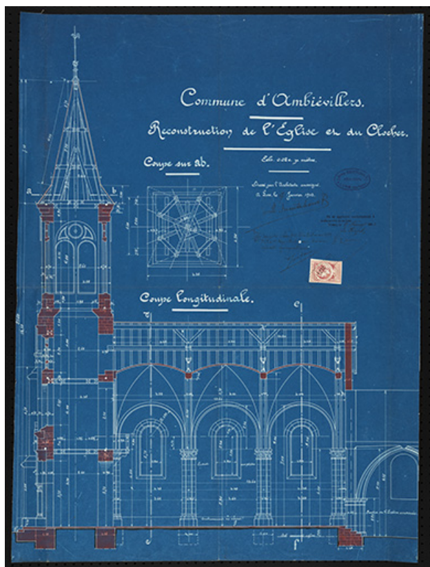
Plan présentant le projet de reconstruction du clocher et de la nef, coupe longitudinale.
