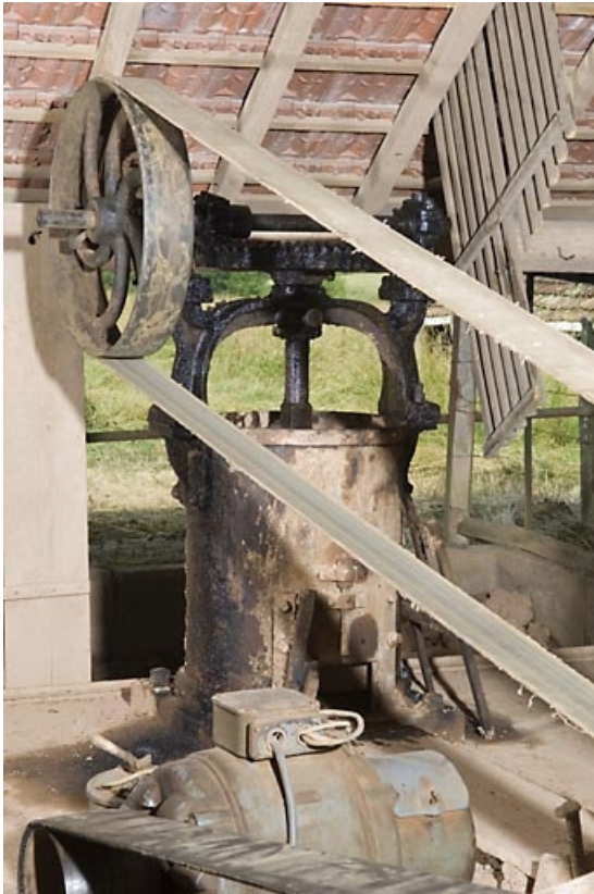
Malaxeur et moteur électrique.
