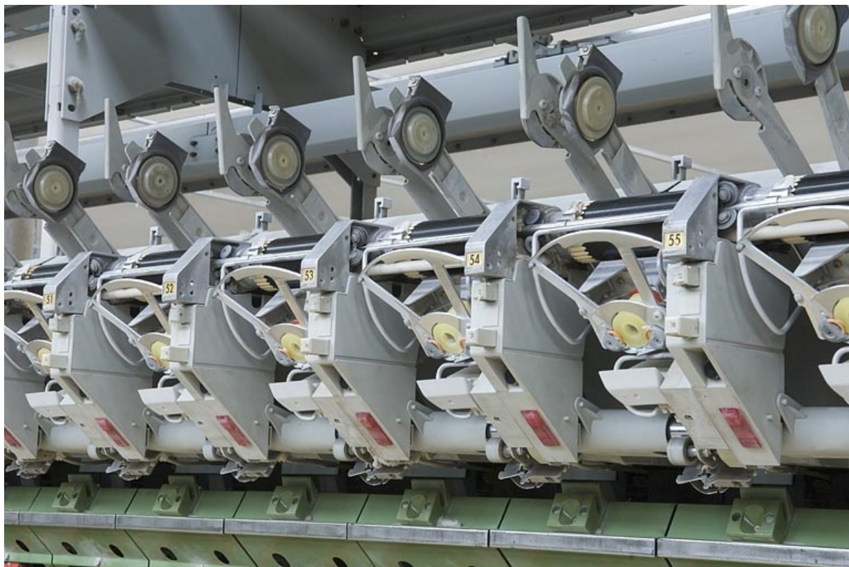
Têtes de continu à filer Autocoro.
