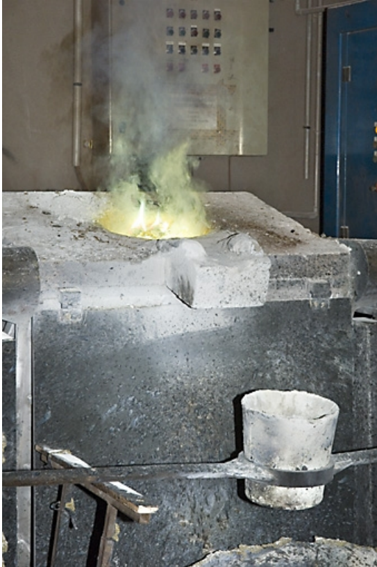
Four électrique. Bascule du four pour la coulée. 70, Saint-Sauveur, 44 rue du Maréchal Lyautey
