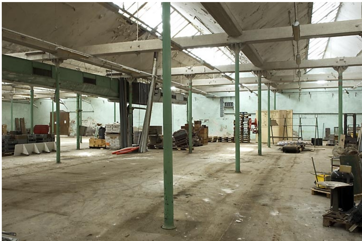
Atelier de fabrication de l'ancienne filature. Travées délimitées par des colonnes de fonte et couvertes de sheds. 70, Saint-Sauveur, 44 rue du Maréchal Lyautey
