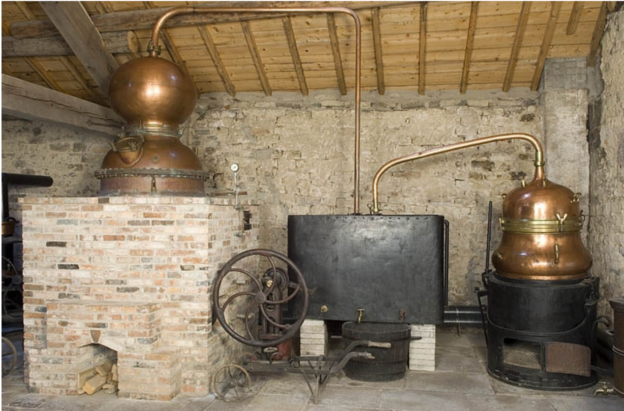
Alambics, chaudières et réfrigérant (au centre).
