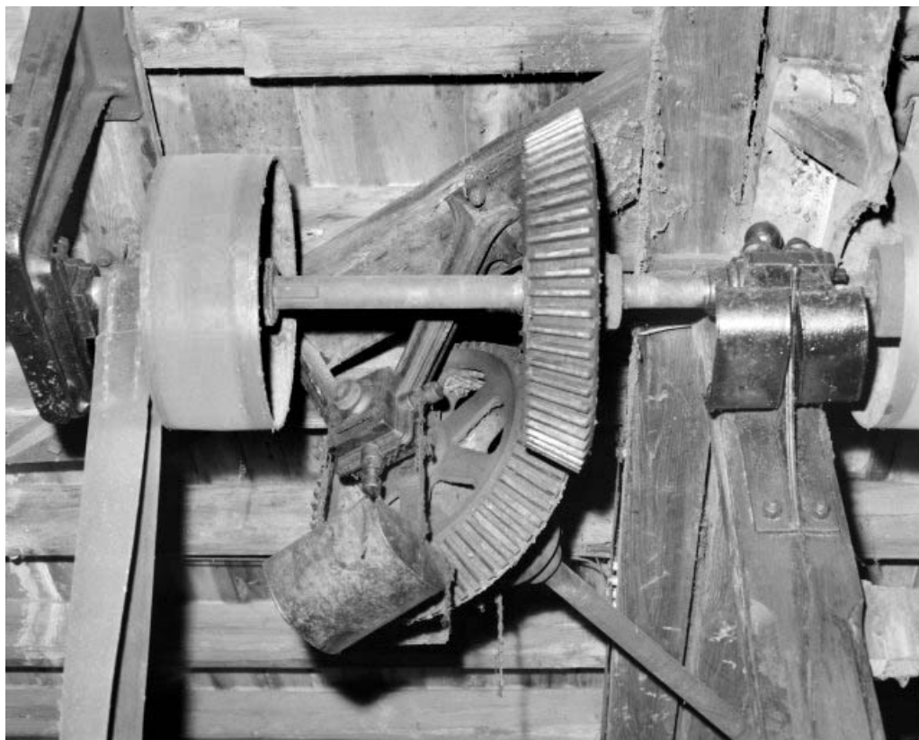
Renvoi de la transmission vers l'atelier de filature (N).
