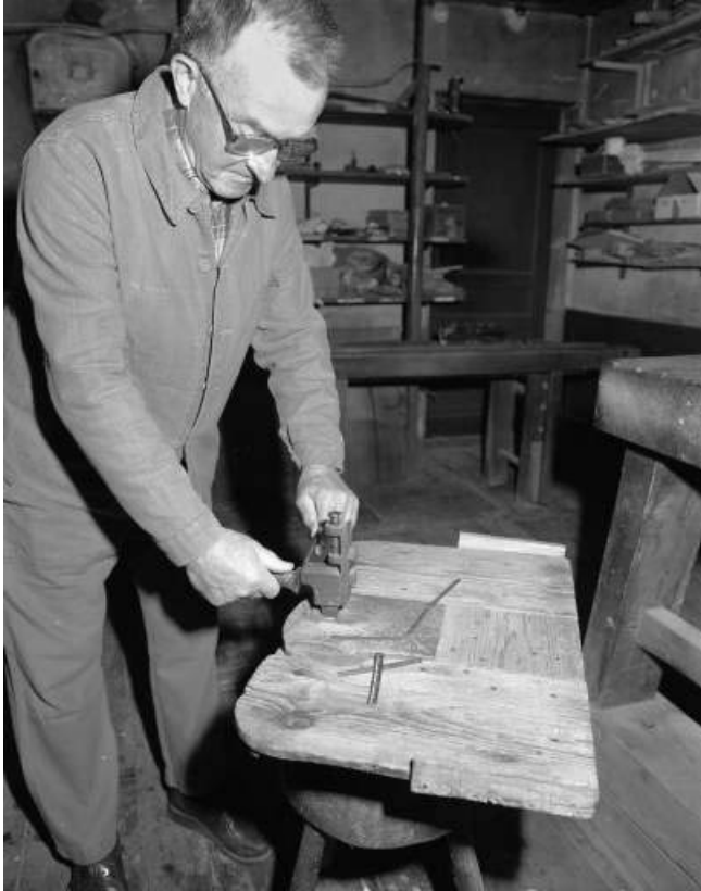
Mise au gabarit du "clou".
