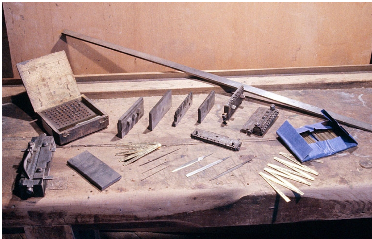
Poinçons, mètre-étalon et mètres pliants.
