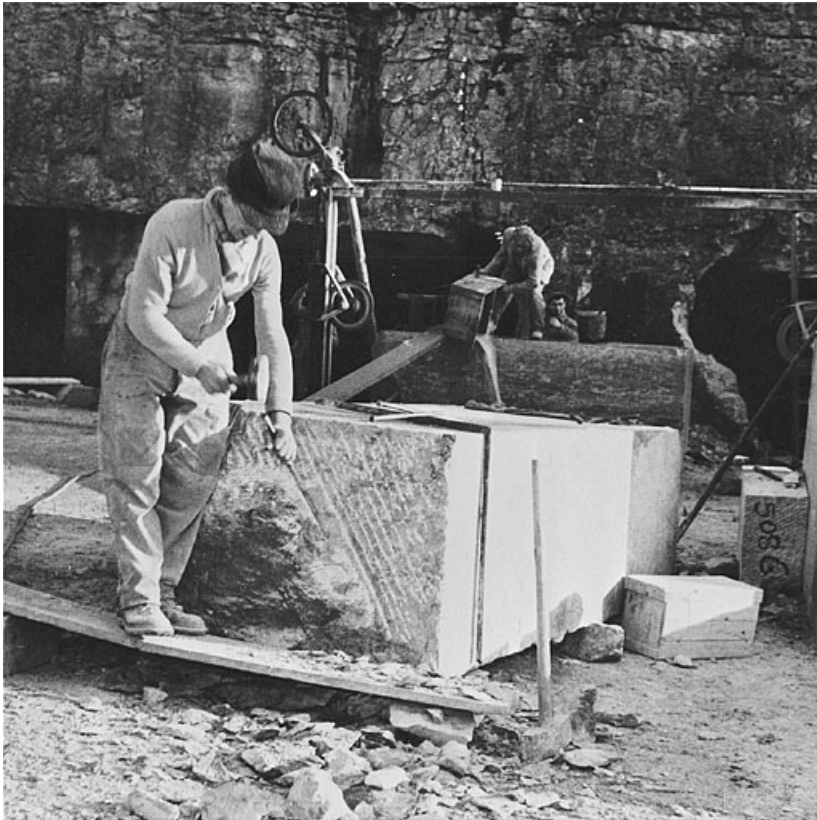
Brochage de la face d'un bloc taillé au fil hélicoïdal.
