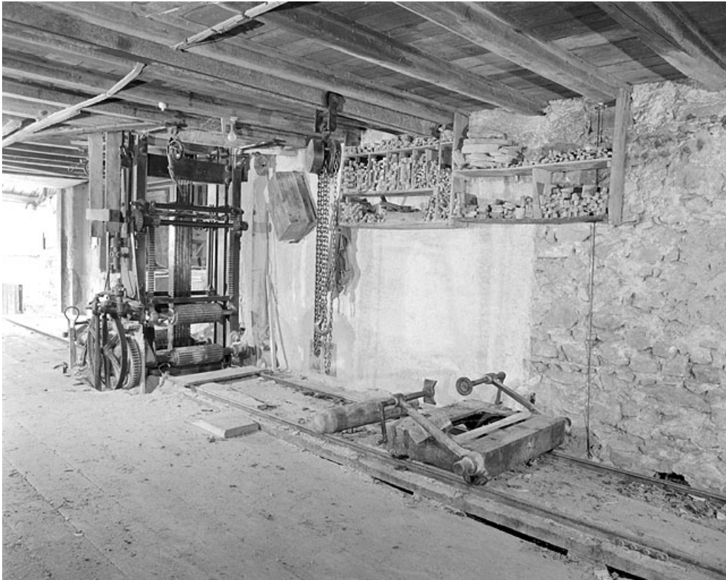
Châssis multiple et chariot.
