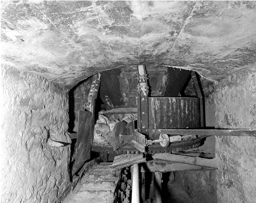
Extracteur d'un four à surcuit.
