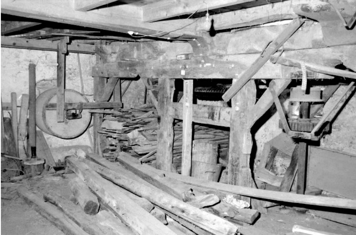
Tonneau de polissage et transmission (2e étage de soubassement). 39, Villards-d'Héria
