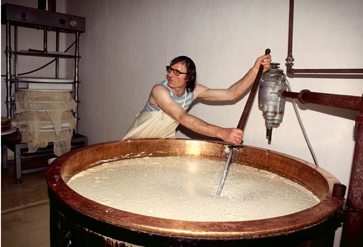
Décaillage au tranche-caillé manuel.
