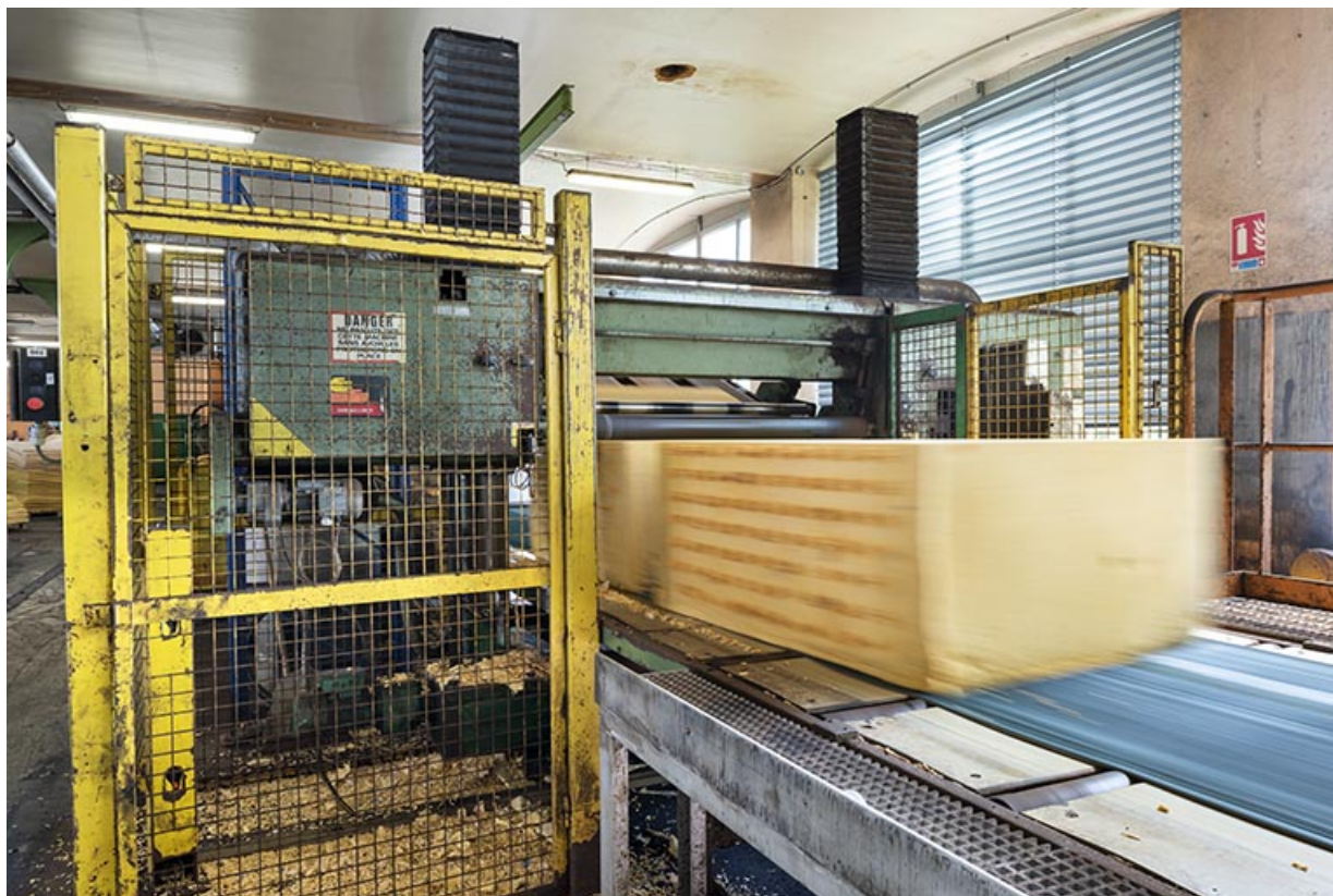
Fabrication : découpe d'un bloc en plaques.
