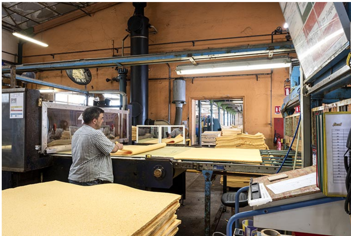
Fabrication : découpe et contrôle des plaques.
