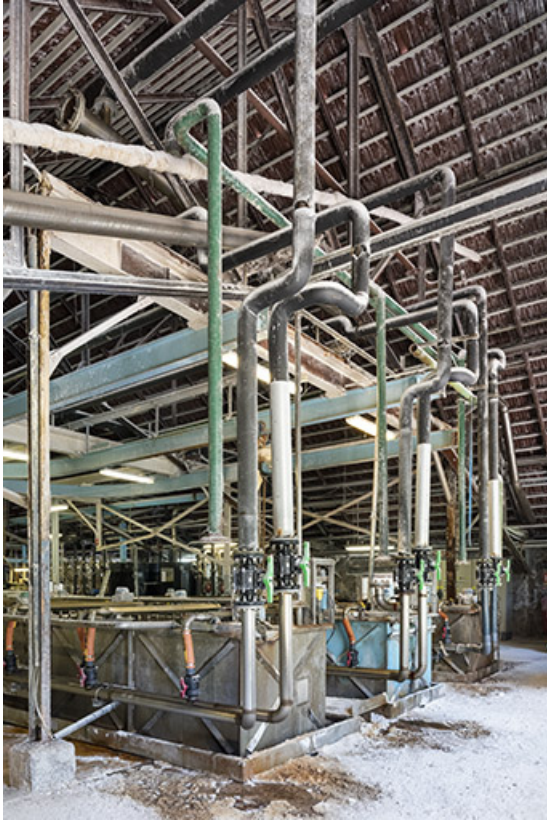
Fabrication : retraitement du sel (cristallisation).
