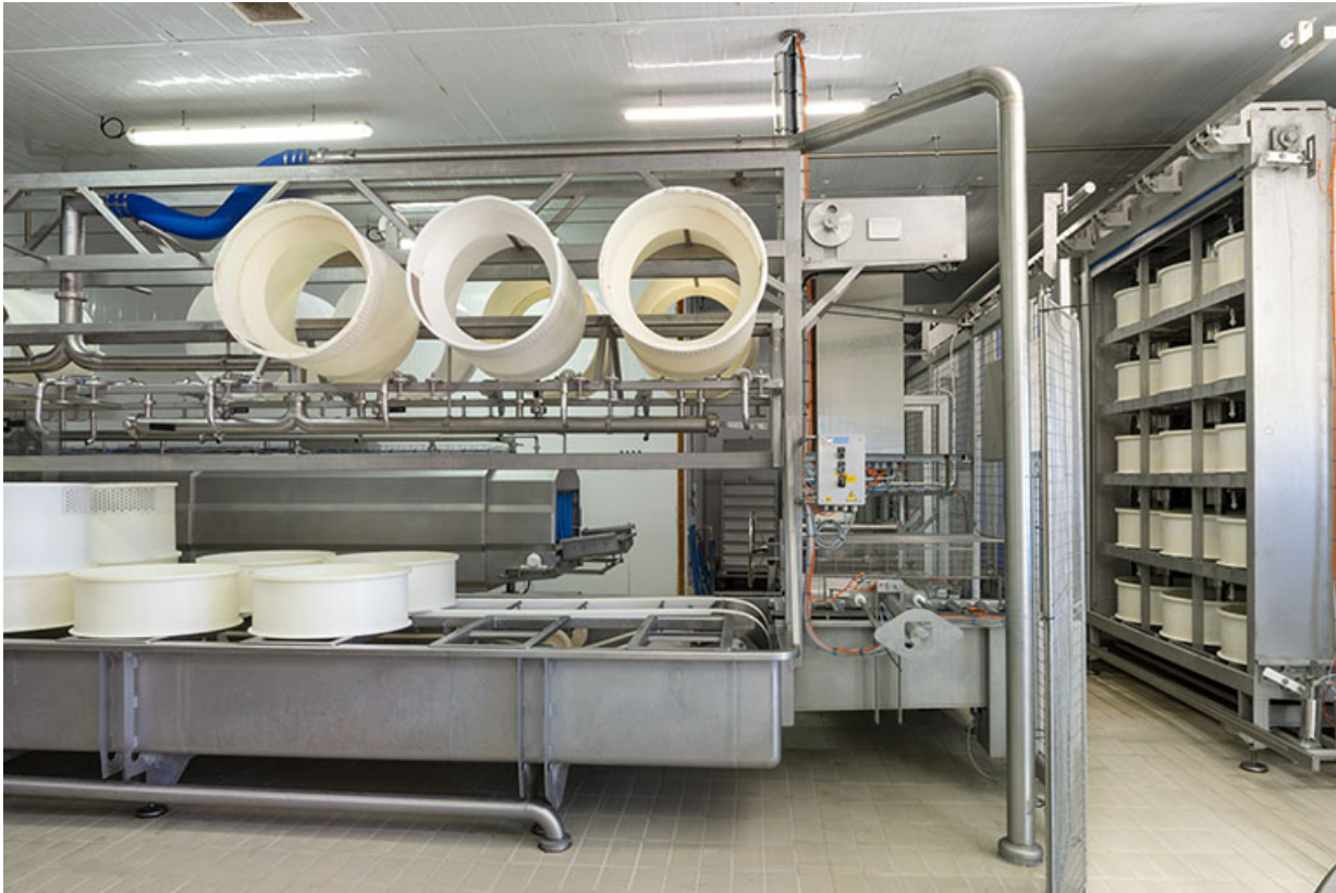
Atelier de fabrication : installations de soutirage et moulage à gauche, de pressage à droite. 25, Les Fins, 2 rue du Paradis
