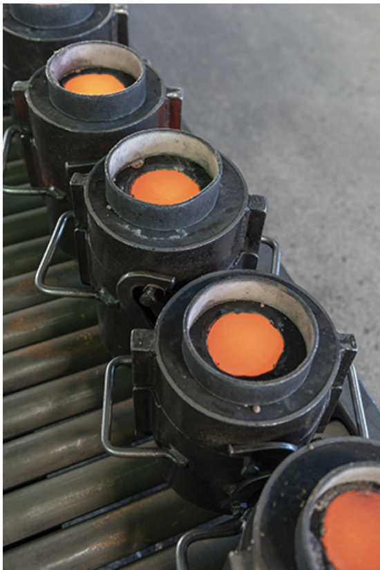
Refroidissement du bronze dans des petits châssis.
