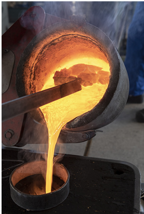
Coulée dans un grand châssis : les scories sont éloignées à l'aide d'une barre métallique.
