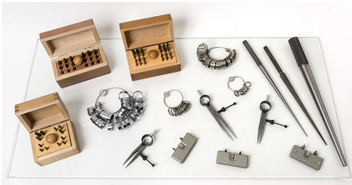
Production de la société Grandidier : jeux de fraises, triboulets, baguiers, compas et clés à ouvrir les fonds de boîte de montre. 25, Grand'Combe-Château, 14 rue les Grands Saules, lieudit : les Forges
