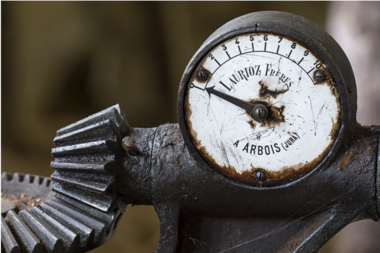
Usine : manomètre de la commande de la turbine Laurioz.
