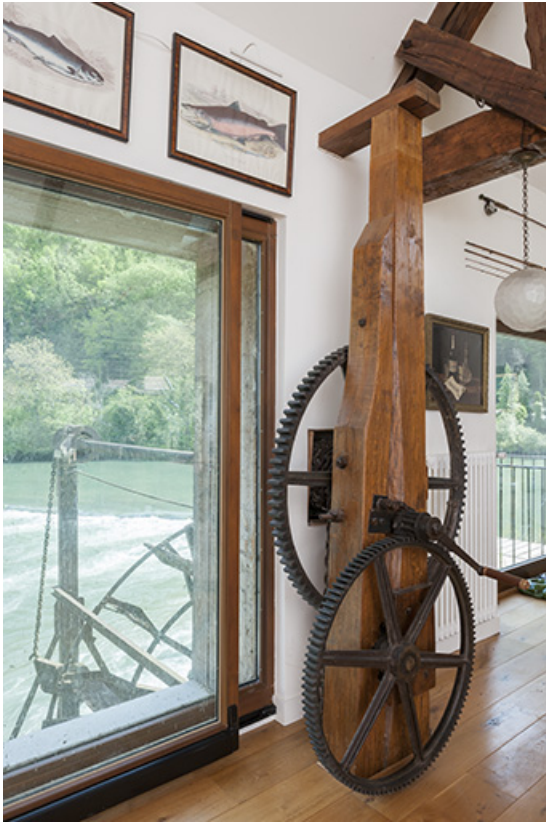
Etage du moulin. Mécanisme de levage de la roue hydraulique.
