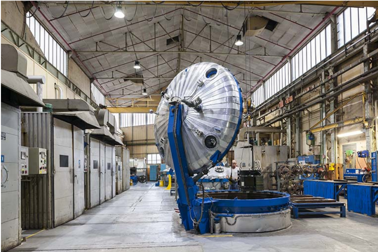
Atelier d'imprégnation (autoclave ouvert).
