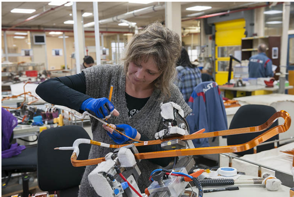
Isolation manuelle des barres de cuivre.
