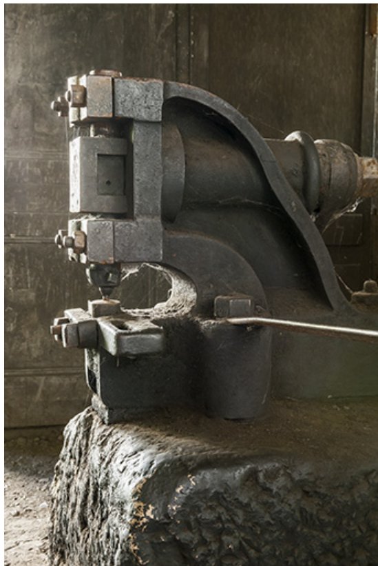
Atelier de mécanique. Poinçonneuse vue de côté.
