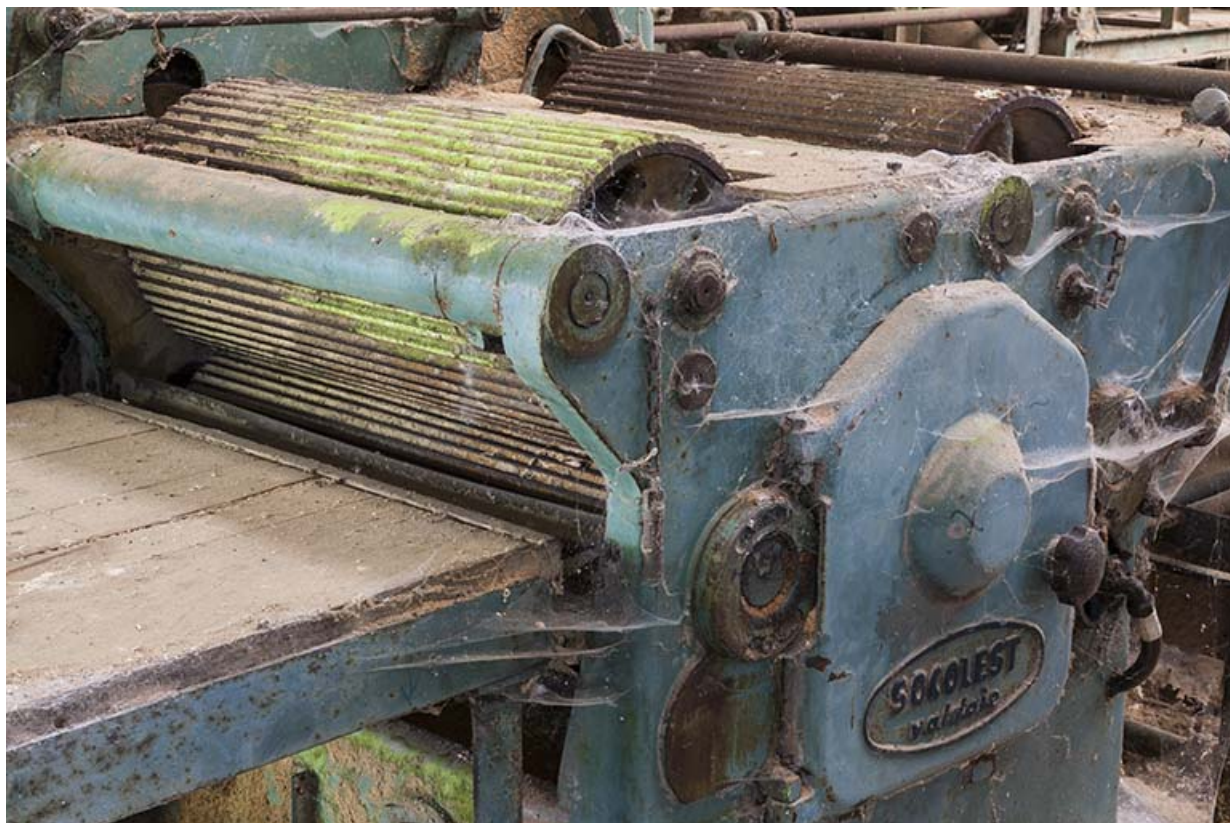
Déligneuse. Détail des rouleaux cannelés.
