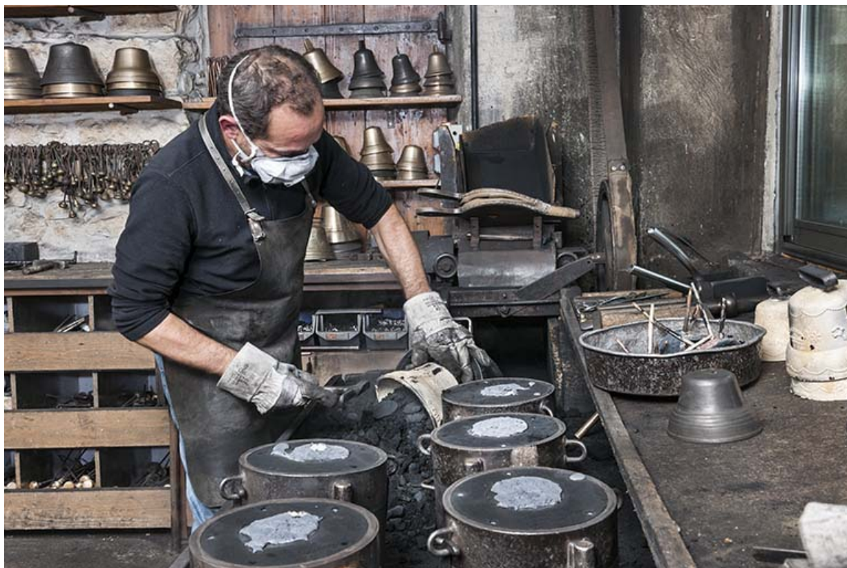
Démoulage. Extraction de la cloche (4).
