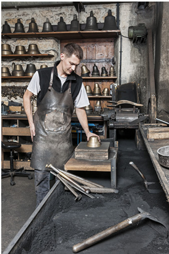
Moulage. Positionnement du modèle (donne l'empreinte extérieure).
