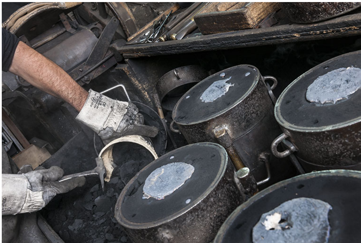
Démoulage. Extraction de la cloche (1).
