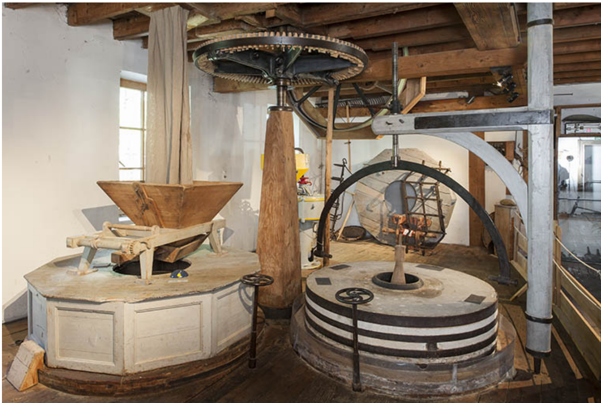
Premier étage. Meules, potence et transmission.
