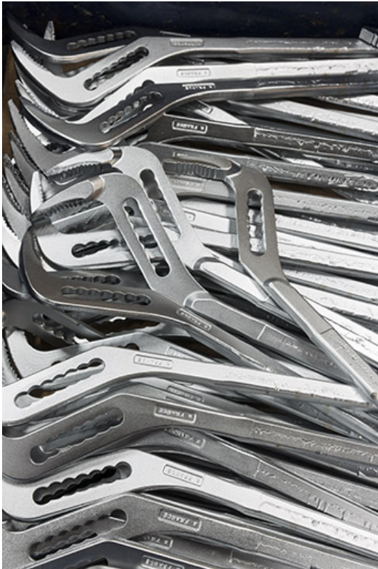
Branches de pinces avant assemblage.
