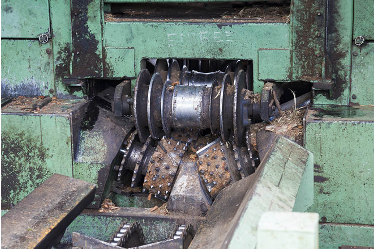
Installation de billonnage : détail des rouleaux.
