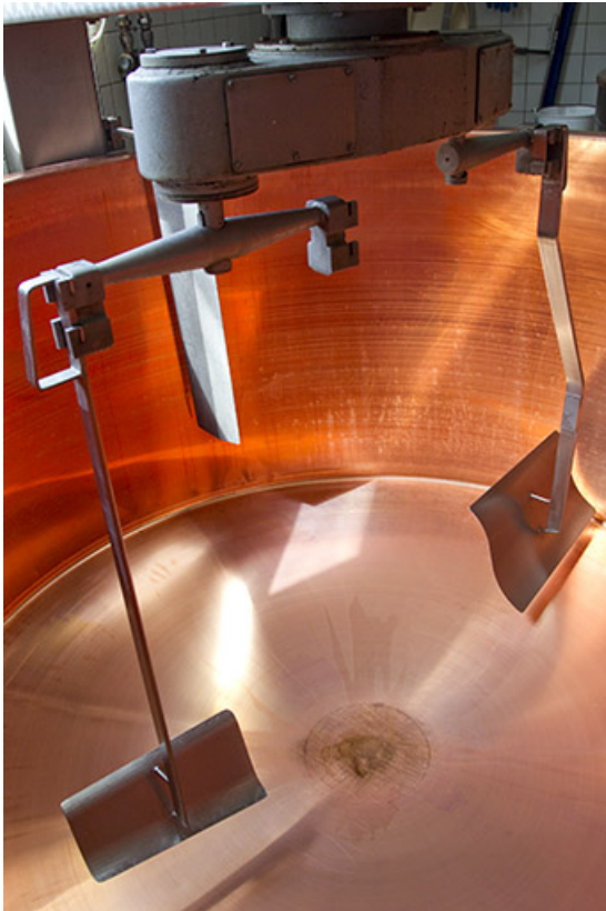
Cuve de fabrication : outils de brassage.
