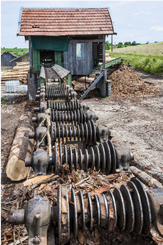
Rouleaux d'entraînement du poste d'écorçage.
